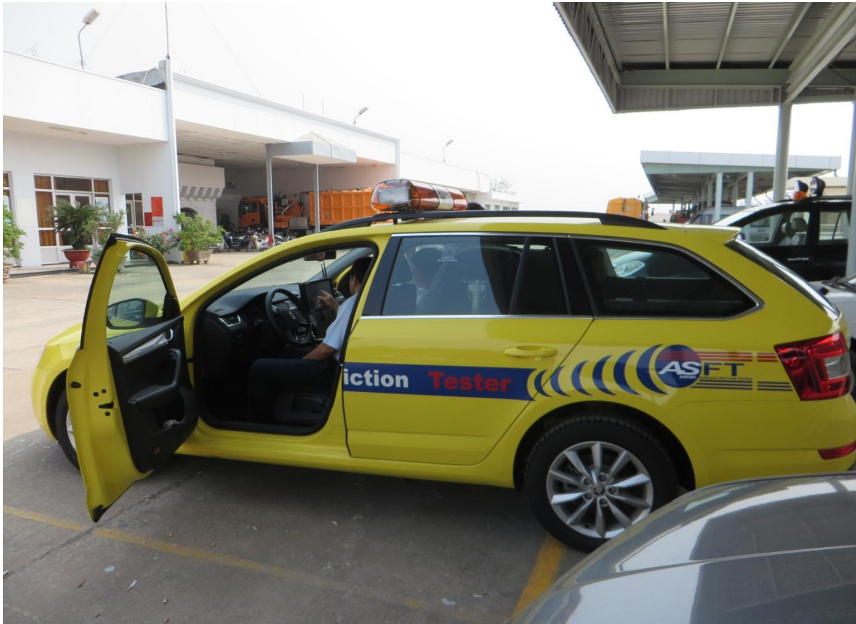
Hình H-1: Xe ASFT của CHKQT Tân Sơn Nhất
