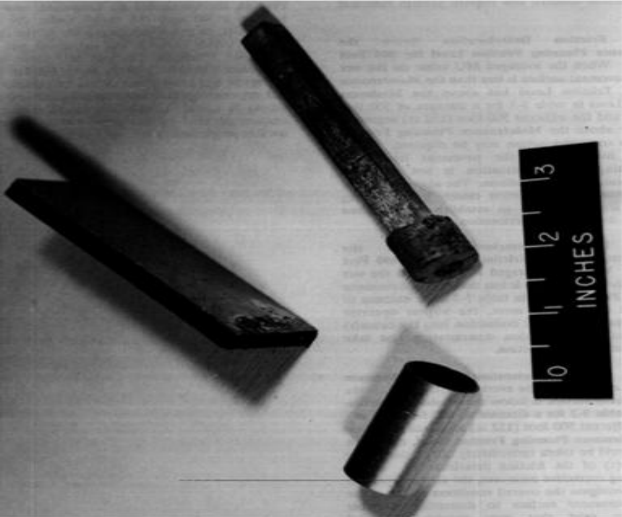
Hình 10. Ống đo bơm mỡ, pit tông, và cây chổi cao su
